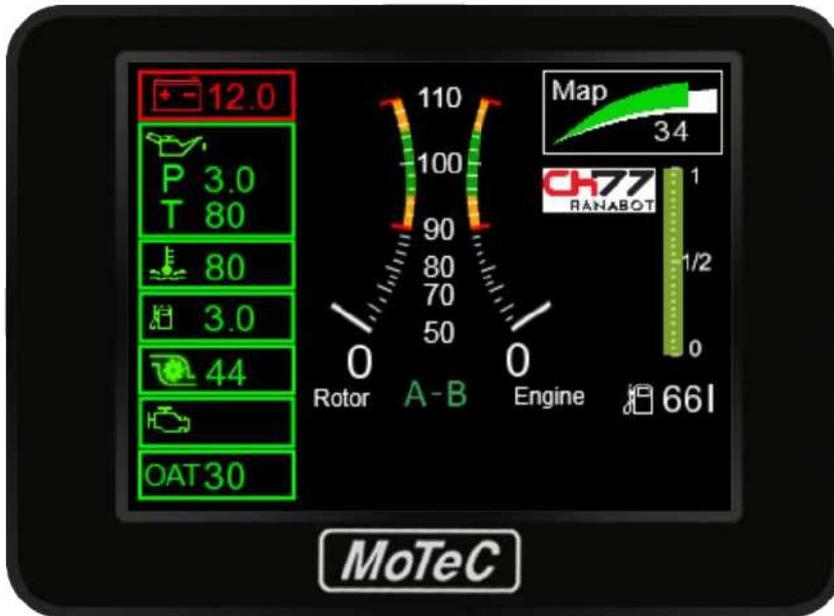
Au milieu, vous avez des informations sur le rotor et le régime moteur en%, mais pendant le ralenti, une petite fenêtre apparaît sous les deux jauges avec le texte au ralenti et la valeur du régime moteur en tr / min.
