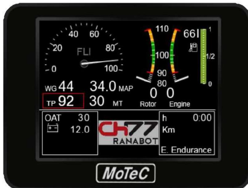
Cette page est très simple, vous ne voyez que la plupart des valeurs. Les autres paramètres n'apparaissent que s'ils dépassent la valeur de fonctionnement. Par exemple, si la température de l'eau est élevée, une barre d'alarme apparaît en bas de la page.
