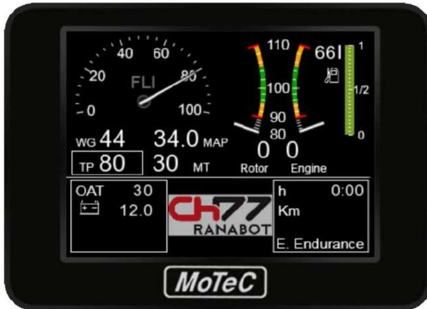
Lorsque le régime du moteur dépasse 4500 tr / min, le système EIS commute automatiquement la page n.3 et affiche l'instrument FLI.
