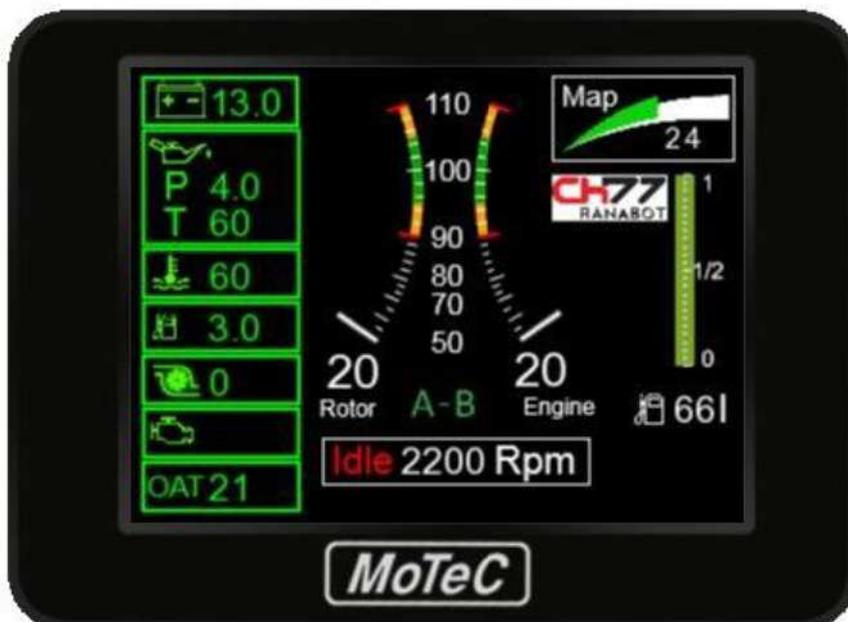
Dans la partie droite de l'écran, vous pouvez voir une quantité de niveau de carburant stockée dans le réservoir et la valeur de pression d'air du collecteur en InHg.
