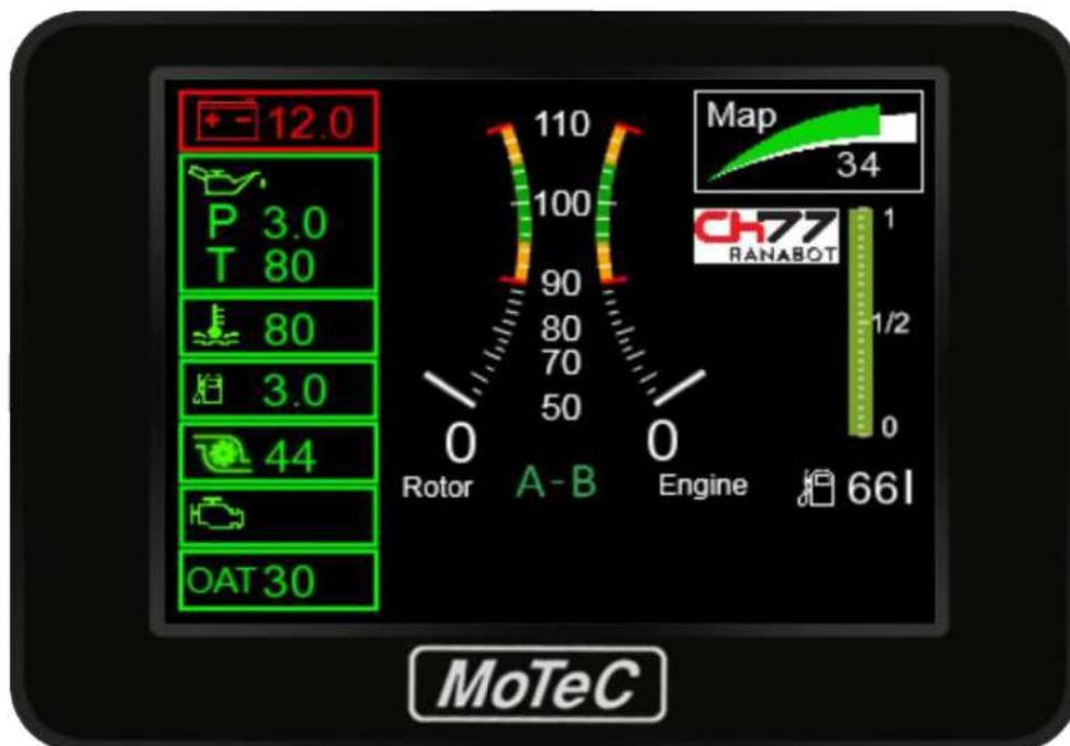
température de la boîte de vitesses et température de l'air extérieur OAT. Les étiquettes changent de couleur en fonction de l'état du moteur.
